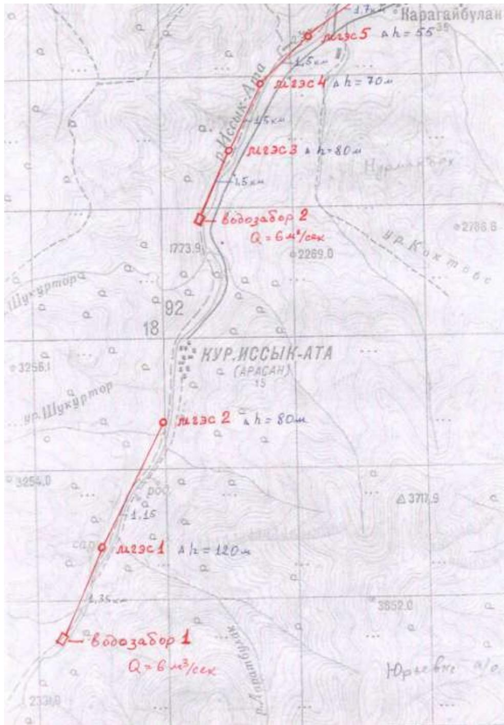
Рис. 1.5.3 Схема расположения МГЭС №1-5 с водозаборами №1-2
